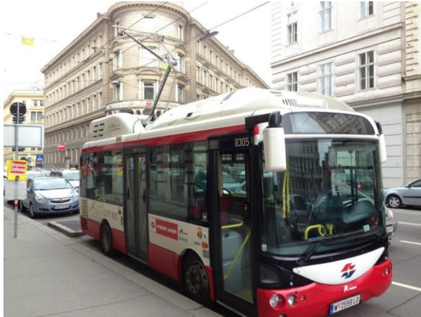
17. ábra: Elektromos autóbusz tölti az akkumulátorait felsővezetékéről a végállomáson, Bécsben
