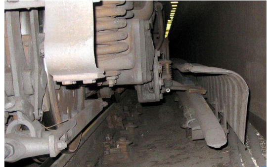
23. ábra: Áramszedő papucs harmadik sínes energiaellátási rendszerhez
