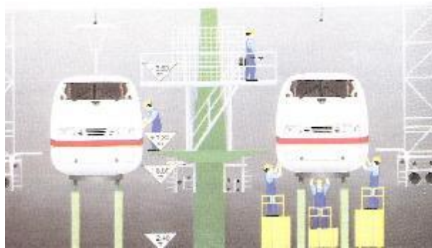
3. ábra: A hamburg-eidelstedti IC üzemi pályaudvar járműcsarnokának munkaszintjei
