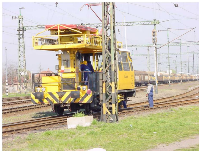
2. ábra: Speciális felsővezeték-szerelő jármű
