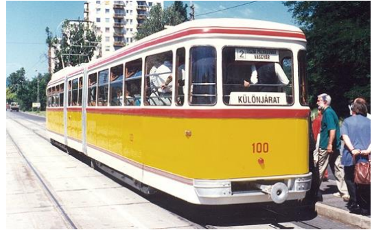
22. ábra: Egyirányú, egyoldali ajtós, csuklós jármű
